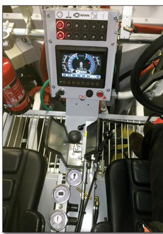
① H33-4 stroj za označavanje cesta sa spremnikom bez pritiska (570 ltr) za termoplastiku sa MultiDotLine® univerzalnim extruderom, savitljiv ispod spremnika, extruder 50 cm
