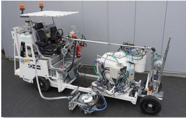
Markierstellung: Extruder seitlich neben dem Behälter
