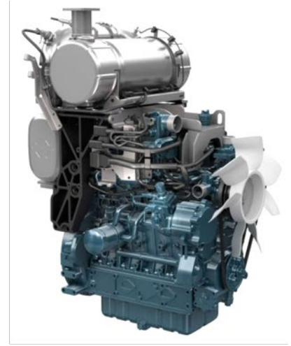
Три варианта одного и того же двигателя – KUBOTA V3800 в виде: Фаза II без маркировки (74,0 кВт), Фаза V с DOC+DPF (55,4 кВт) и Фаза V с DOC+DPF+SCR (86,4 кВт).
