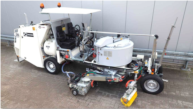
Posición marcaje: Extrusor giratorio al lado del depósito
