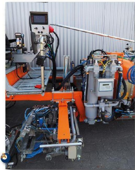
Способ дозирования: сифонный насос основного компонента 98%, а также зубчатый насос отвердителя 2% для 2-х компонентных хол. пластиков с MALCON4E
