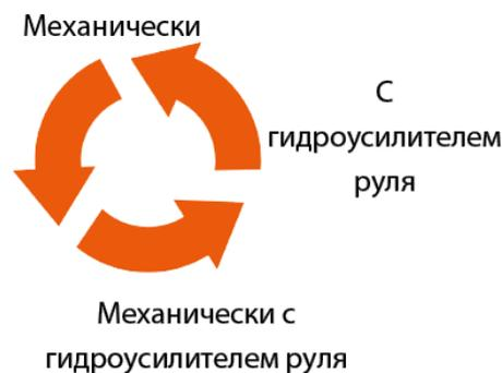
Недостаток механического рулевого управления заключается в том, что для маневрирования машиной требуется слишком большое усилие. С другой стороны, из-за требуемого большого усилия рулевое управление нечувствительно к помехам со стороны рулевого колеса, что упрощает поддержание точного направления при разметке.
