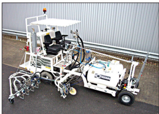
H18 bei Royal Air Force/UK mit 1K Kaltfarben Airless System (zwei Pumpen) für den Einsatz mit 90 cm Breitstrichmarkeur mit 4 Farb- und Perlpiستolen sowie 3 Farb- und Perlpiستolen für „taxiways“ in schwarz/gelb/schwarz, 2 x 225 ltr Druckbehälter
