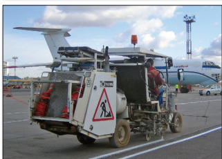
H26 in St. Petersburg/Russland mit 1K Kaltfarben sowie 2K-Kaltspritzplastik Airless System 98:2, 460 ltr Druckbehälter für den Einsatz mit einer Farb- bzw. 2K-Spritzpistole für „taxiways“
