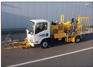
H36-800P in Hongkong/China mit 1K-Kaltfarben Airless System für den Einsatz mit 90 cm Breitstrichmarkeur mit 4 Farbpistolen und Perlpiستolen, 1 x 385 ltr und 2 x 220 ltr (geteilt) Druckbehälter
