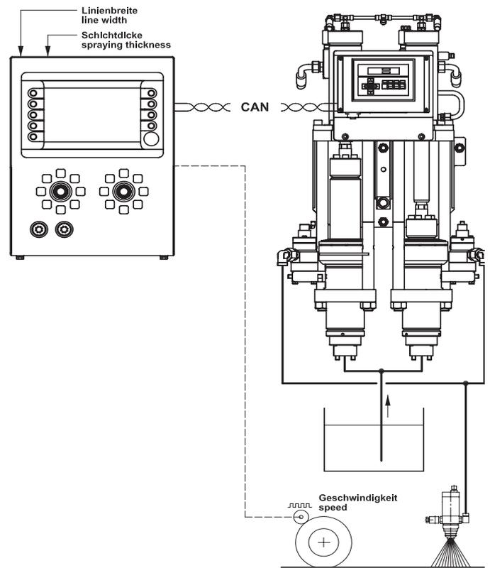
Se introducen el ancho y el espesor de la línea en el dispositivo MALCON4.
