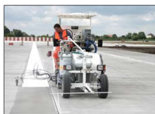
H26 en Saint-Petersbourg/Russie avec système de peinture à froid de 1-composant ainsi que avec système Airless 98:2 pour d'enduits à froid 2-composants pulvérisés, réservoir sous pression 460 l, pour utilisation avec un pistolet de peinture ou bien un pistolet de 2-composants pour des taxiways
