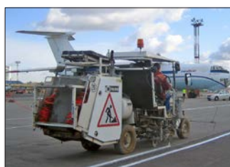
H26 en Saint-Petersbourg/Russie avec système de peinture à froid de 1-composant ainsi que avec système Airless 98:2 pour d'enduits à froid 2-composants pulvérisés, réservoir sous pression 460 l, pour utilisation avec un pistolet de peinture ou bien un pistolet de 2-composants pour des taxiways
