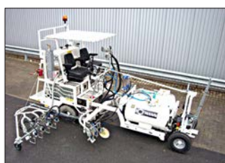
H18 pour Royal Air Force/UK avec système pour peinture à froid de 1-composant Airless (deux pompes), marqueur aéroportuaire 90 cm avec 4 pistolets de peinture et billes de verre ainsi que 3 pistolets de peinture et billes de verre pour taxiways (noir/jaune/noir), 2 x 225 l réservoir sous pression
