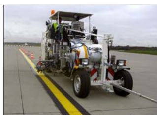
H36-800P en Hongkong/Chine pour peinture à froid de 1-composant Airless avec marqueur aéroportuaire 90 cm avec 4 pistolets de peinture et billes de verre, 1 x 385 l et 2 x 220 l (divisé) réservoirs sous pression
