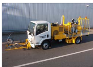
H36-800P en Hongkong/Chine pour peinture à froid de 1-composant Airless avec marqueur aéroportuaire 90 cm avec 4 pistolets de peinture et billes de verre, 1 x 385 l et 2 x 220 l (divisé) réservoirs sous pression
