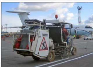
H26 en San Petersburgo/Rusia equipada para pinturas en frío de 1-componente así como sistema Airless 98:2 para plásticas en frío pulverizables de 2-componentes, depósito presurizado de 460 l, para el uso con una pistola de pintura o bien una pistola de 2-componentes para taxiways
