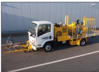
H36-800P en Hong Kong/China para pinturas en frío de 1-componente Airless con marcador aeroportuario de 90 cm y 4 pistolas de pintura y esferas, 1 x 385 l y 2 x 220 l (dividido) depósitos presurizados
