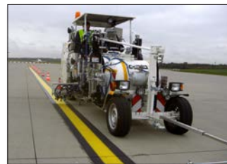
H33 en Hamburgo / Alemania con sistema de pinturas en frío de 1-componente Airless con 5 bombas Airless, 1 x 460 l y 2 x 220 l así como 2 x 110 l depósitos presurizados ...
