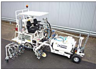
H18 para Royal Air Force/UK con sistema de pinturas en frío de 1-componente Airless (dos bombas) con marcador aeroportuario de 90 cm y 4 pistolas de pintura y esferas así como 3 pistolas de pintura y esferas para aplicar taxiways (negro/amarillo/negro), 2 x 225 l depósito presurizado
