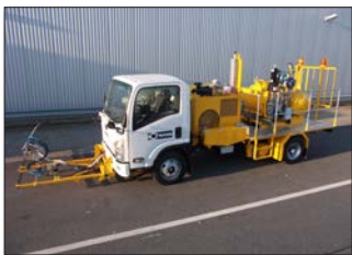
H36-800P in Hongkong/China mit 1K-Kaltfarben Airless System für den Einsatz mit 90 cm Breitstrichmarkeur mit 4 Farbpistolen und Perlpietolen, 1 x 385 ltr und 2 x 220 ltr (geteilt) Druckbehälter
