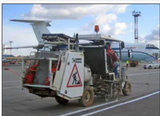
H26 in St. Petersburg/Russland mit 1K Kaltfarben sowie 2K-Kaltspritzplastik Airless System 98:2, 460 ltr Druckbehälter für den Einsatz mit einer Farb- bzw. 2K-Spritzpistole für „taxiways“
