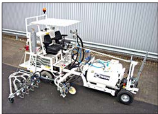
H18 bei Royal Air Force/UK mit 1K Kaltfarben Airless System (zwei Pumpen) für den Einsatz mit 90 cm Breitstrichmarkeur mit 4 Farb- und Perlpietolen sowie 3 Farb- und Perlpietolen für „taxiways“ in schwarz/gelb/schwarz, 2 x 225 ltr Druckbehälter
