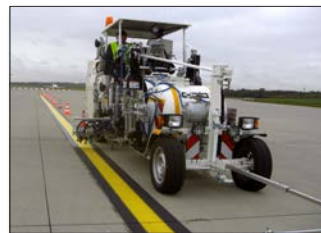
H36-800P in Hongkong/China mit 1K-Kaltfarben Airless System für den Einsatz mit 90 cm Breitstrichmarkeur mit 4 Farbpistolen und Perlpietolen, 1 x 385 ltr und 2 x 220 ltr (geteilt) Druckbehälter
