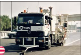
H75-2500P Basınçsız Tanklar ile Kamyona Monteli Yol Çizgi Makinası (2 500 l) spreplastik ve (AMAKOS®) pompalı
