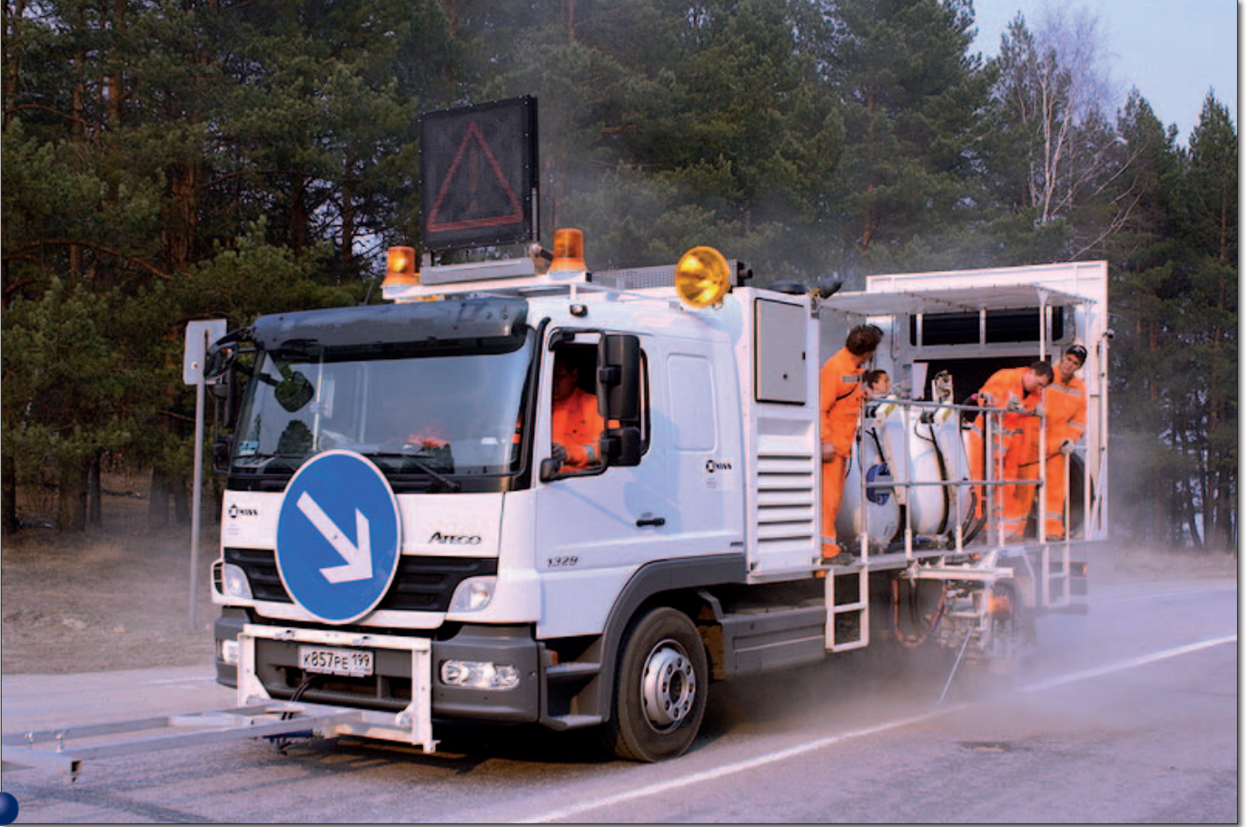
H36-2000P kamyona monteli yol çizgi makinası, (2 x 1000 l) basınçlı soguk boya tankı, Airless metodlu hızdan bagimsız sabit metrajlama pompası (AMAKOS®), her iki tarafta işaretleme ünitesi
