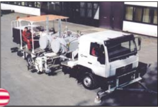
H75-1000 Kamyona Monteli Yol Çizgi Makinası (2 x 500 l) basınçlı spreplastik tankları , her iki tarafta işaretleme ünitesi
