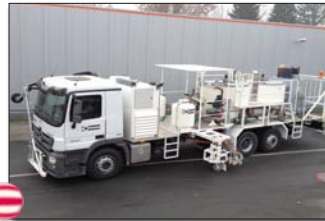
H75-3400P Kamyona monteli yol çizgi makinası ile basınçsız spreplastik tank (2 x 1700 l), ile vida pompa, her iki tarafta işaretleme ünitesi
