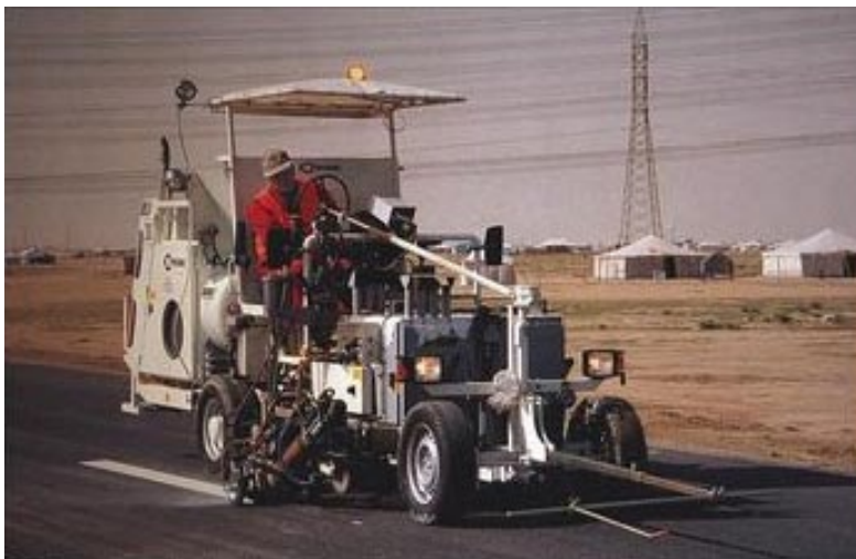
Weltweit im Einsatz und sehr begehrt: Ein Straßenmarkier-Fahrzeug der Hofmann GmbH bei der Arbeit in der Wüste von Kuwait.
