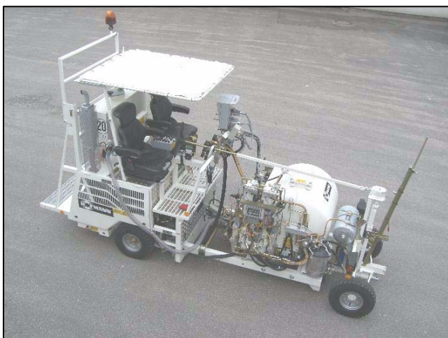
H18-1 mit 2-Komponenten Kaltpritzplastik-Ausrüstung (Airless) im Mischungsverhältnis 98 : 2
