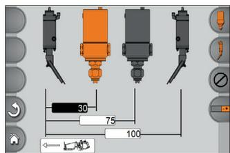
Управление максимально четырьмя выстроенными в ряд маркировочными единицами, как напр., пистолетами для краски и стеклошариков или задвижками экструдера.
