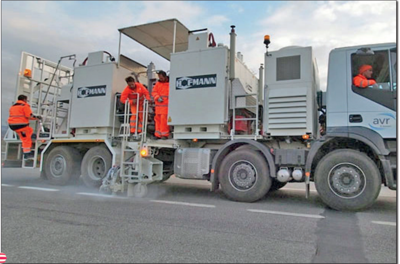
H75-4000P avec réservoir sans pression (4 x 1.000 l) pour l'enduits à chaud pulvérisés avec pompe à vis, marqueurs bilatéral
