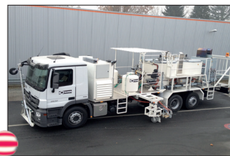
H75-3400P avec réservoirs sous pression (2 x 1 700 l) pour enduits à chaud pulvérisables avec pompe à vis, unité de marquage bilatérale
