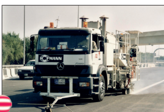
H75-2500P avec réservoir sous pression (2 500 l) pour enduits à chaud pulvérisables avec pompe de dosage dépendante de la voie (AMAKOS®)
