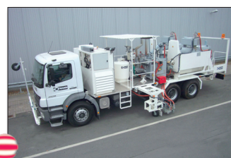
H75-2500 avec fondoirs (2 x 1 000 ltr) et réservoirs sous pression (500 l) pour enduits à chaud pulvérisables, unité de marquage bilatérale
