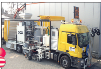
H75-3000EX avec fondoirs (2 x 1100 l) ainsi que réservoir sous pression (800 l) pour enduits à chaud pulvérisés. Unité de marquage pour enduits à chaud ainsi que extrudeuse MultiDotLine® bilatérale. Auto-chargeement par grue assemblé
