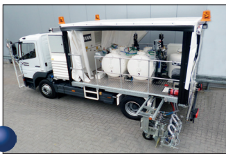
H36-1300P avec réservoirs sous pression (650 l) pour peintures à froid pour mode de pulvérisation Airless, avec marqueur aéropoutuaire 90 cm avec 4 pistolets de peinture et 4 pistolet de billes de verre
