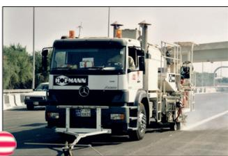
**H75-2500P** con depósito sin presión (2 500 lts) para termoplásticos proyectables con bomba con dependencia del trayecto (AMAKOS®)
