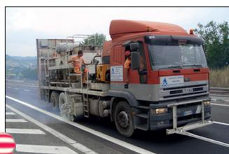
**H75-3000P** Camión pintabandas con depósitos sin presión (2 x 1 500 lts) para termoplásticos proyectables con bomba con dependencia del trayecto (AMAKOS®), marcadores en ambos lados
