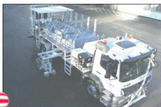
**H75-1500** con depósitos presurizados (3 x 500 lts) para termoplásticos proyectables, marcadores en ambos lados
