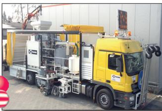
**H75-3000EX** incluso calderas (2x1100 l) así como depósitos presurizados (800 l) para termoplásticos pulverizables. Grupo marcador para termoplásticos pulverizables así como extrusor MultiDotLine® en ambos lados. Auto-carga a través de una grúa montada
