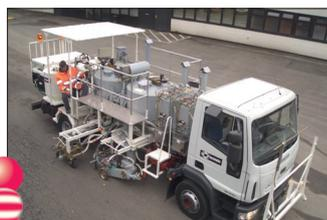
**H75-1000PEX** Camión pintabandas multiuso con depósito presurizado (2 x 600 lts) para termoplásticos:
