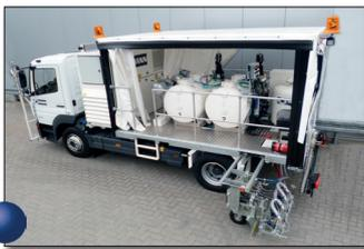
**H36-1300P** con depósitos presurizados (2 x 650 lts) para pinturas en frío para el procedimiento Airless, con marcador aeroportuario de 90 cm, 4 pistolas de pintura y 4 pistolas de esferas
