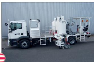
**H75-1500** con calderas (2 x 600 lts) así como depósito presurizado (500 lts) para termoplásticos proyectables, marcadores en ambos lados
