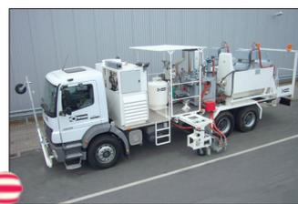
**H75-2500** con calderas (2 x 1 000 lts) así como depósito presurizado (500 lts) para termoplásticos proyectables, marcadores en ambos lados
