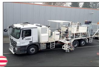
**H75-3400P** con depósitos sin presión (2 x 1 700 lts) para termoplásticos proyectables con bomba helicoidal, marcadores en ambos lados
