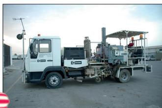
**H75-500** con depósito presurizado (500 lts) para termoplásticos proyectables, marcadores en ambos lados
