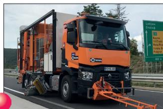
**H60-2500EX** con calderas (2 x 1100 l) y depósito de alimentación (300 l) para termoplásticos, extrusora universal MultiDotLine® de 50 cm en ambos lados para tacos/multi-puntos y líneas lisas
