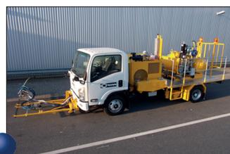
**H36-800P** con depósitos presurizados (1 x 385 lts y 2 x 220 l (compartido)) para pinturas en frío aplicando en modo Airless, con marcador aeroportuario de 90 cm y 4 pistolas de pintura
