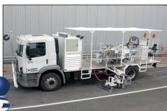
**H37-1000P** Camión pintabandas combinado con depósitos presurizados (2 x 540 lts) para pinturas en frío y pinturas plásticas en frío de 2-comp.proyectables,relación de mezcla 98:2,aplicando en modo Airless con bomba con dependencia del trayecto (AMAKOS®)
