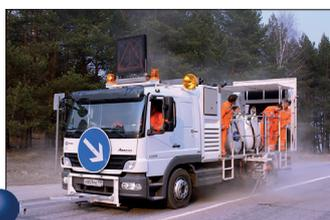
**H36-2000P** con depósitos presurizados (2 x 1 000 l) para pinturas en frío para el procedimiento Airless en servicio AMAKOS®, marcadores en ambos lados
