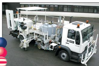
**H75-1000PEX-CP** Camión pintabandas multiuso con depósito presurizado (600 lts) para termoplásticos-y depósito presurizado (540 lts) para pinturas en frío-: a) para termoplásticos proyectables con bomba con dependencia del trayecto (AMAKOS®), marcadores en ambos lados; b) para termoplásticos con dos extrusores universales en ambos lados así como c) para pinturas en frío con marcadores en ambos lados
