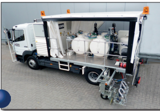
H36-1300P mit Druckbehältern (2 x 650 ltr) für Kaltfarben für Airless-Spritzverfahren, 90 cm Breitstrichmarkeur mit 4 Farb- und Perlpistolen
