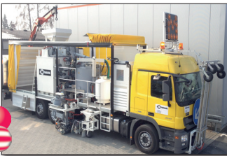
H75-3000EX mit Kochern (2 x 1100 ltr) sowie Druckbehälter (800 ltr) für spritzbare Thermoplastiken. Sprayplastik-Markeureinheit sowie Multi-DotLine® Extruder beidseitig. Selbstbeladung durch einen aufgebauten Kran
