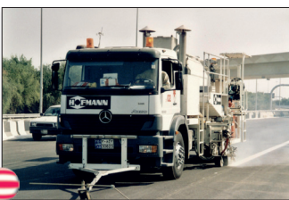
H75-2500P mit drucklosem Behälter (2500 ltr) für spritzbare Thermoplastiken mit wegabhängiger Dosierpumpe (AMAKOS®)
