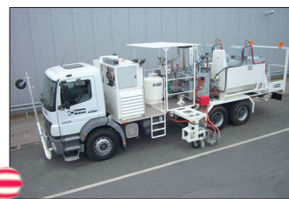
H75-2500 mit Kochern (2 x 1000 ltr) sowie Druckbehälter (500 ltr) für spritzbare Thermoplastiken, Markeureinheit beidseitig
