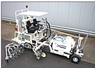
H18 H18 на Royal Air Force (королевские воздушные силы)/ Великобритания с вакуумной системой для 1-компонентных холодных красок (2 вакуумных насоса) для использования на маркировщике шириной 90 см, с 4 пистолетами для краски и стеклошариков, а также дополнительными 3 пистолетами для краски и стеклошариков для рулежных дорожек (черного/желтого/черного цвета), 2 x 225 л бака под давлением
