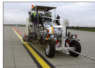
H36-800P в Гонконге/Китай с вакуумной системой для 1К-холодных красок для работы широкополосного маркировщика 90 см с 4 пистолетами для краски и стеклошариков, 1 x 385 л и 2 x 220 л (сепаратные) баллоны под давлением
