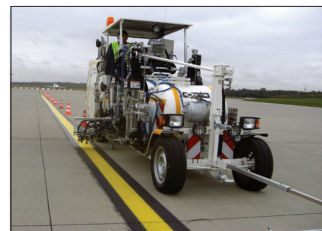
H36-800P w Hong Kongu /Chiny - samochód ciężarowy z zabudowanym systemem do oznakowania farbami jednoskładnikowymi airless, z blokiem malującym o szer. 90 cm wyposażonym w 4 pistolety do farby i granulatu. Zbiorniki ciśnieniowe 1 x 385 l oraz 2 x 220 l (dzielone)
