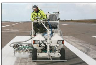
**H18** en Islande avec système du réservoir sous pression pour peinture à froid, 2 x 225 l réservoirs sous pression, marqueur aéroportuaire 90 cm avec 3 pistolets de peinture et billes de verre chacun
