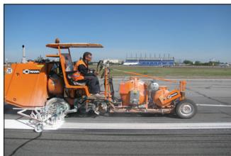
**H26** en Bucarest/Roumanie avec système du réservoir sous pression pour peinture à froid, 1 x 460 l et 1 x 225 l réservoirs sous pression, avec marqueur aéroportuaire 90 cm avec 3 pistolets de peinture et billes de verre chacun ainsi que 2 pistolet de peinture et billes de verre chacun pour des taxiways
