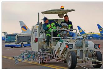
**H33** en Kiev/Ucrania avec système du réservoir sous pression pour peinture à froid, 2 x 385 l réservoirs sous pression, avec marqueur aéroportuaire 90 cm avec 4 pistolets de peinture et billes de verre chacun ainsi que 2 pistolets de peinture et billes de verre chacun pour des taxiways
