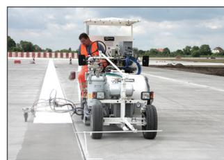
**H26** sur le terrain de la maison Airbus, Hambourg/Allemagne équipée avec système de peinture à froid de 1-composant Airless ainsi que pour enduits à froid 2-composants Airless pulvérisés M98:2, réservoir sous pression 460 l ainsi que marqueur aéroportuaire 90 cm avec 3 pistolets de peinture
