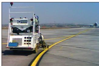
**H18** en Mumbai/Inde avec système pour peinture à froid de 1-composant Airless, 2 x 225 l réservoirs sous pression avec 3 pistolets de peinture pour taxiways (noir/jaune/noir)
