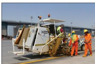
**H33 H 33** en Doha/Qatar avec système de 2 couleurs pour réservoir sous pression pour peinture à froid, 1 x 540 l et 1 x 385 l réservoir sous pression, marqueur aéroportuaire 90 cm avec 4 pistolets de peinture et malaxeur de billes de verre (diffuseur) au travers de 4 pistolets de billes de verre ainsi que chacun 2 pistolets de peinture et billes de verre pour des taxiways
