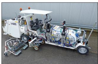
**H33** en Muscat/Oman avec système Airless pour peinture à froid 1-composant, 1 x 460 l et 2 x 220 l réservoirs sous pression, avec marqueur aéroportuaire 90 cm avec chacun 4 pistolets de peinture et billes de verre avec disques ainsi que chacun 3 pistolets de peinture et billes de verre pour des lignes noir/jaune/noir (taxiways) et ...
