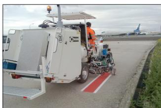
**H26** en Madrid/Espagne avec système du réservoir sous pression pour peinture à froid, 1 x 440 l (2 chambres à 200 l) réservoir sous pression avec 3 pistolets de peinture pour lignes de sécurité (blanche/rouge/blanche)
