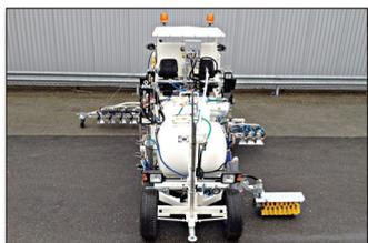
**H33** en Abou Dhabi/E.A.U. avec système pour peintures à froid de 1-composant Airless avec 3 pompes de Airless, 1 x 460 l et 2 x 220 l (divisé) réservoirs sous pression, avec marqueur aéroportuaire 90 cm avec 4 pistolets de peinture et billes de verre et avec 3 pistolets de peinture et billes de verre supplémentaires pour taxiways (noir/jaune/noir)
