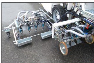
... équipé comme système modulaire avec des fermetures rapides électriques et hydraulique ainsi que des colliers de fixation pour un changement rapide d'unité d'application par chariot élévateur
