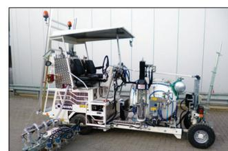
**H18** en Singapour équipé pour peinture à froid de 1-composant Airless, avec marqueur aéroportuaire de 120 cm et avec 5 pistolets de peinture et billes de verre, réservoir sous pression de 460 l
