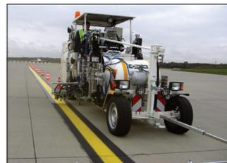
**H33** en Hambourg/Allemagne avec système pour peinture à froid de 1-composant Airless avec 5 pompes de Airless, 1 x 460 l et 2 x 220 l ainsi que 2 x 110 l réservoirs sous pression et avec ...
