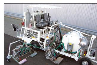
**H18** en Belgrade/Serbie avec système du réservoir sous pression pour peinture à froid, 1 x 460 l réservoir sous pression, marqueur aéroportuaire 90 cm avec 3 pistolets de peinture et disques ainsi que 1 pistolet de peinture avec disques pour des „taxiways“
