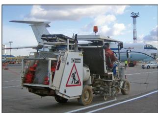
**H26** en Saint-Petersbourg/Russie avec système de peinture à froid de 1-composant ainsi que avec système Airless 98:2 pour d'enduits à froid 2-composants pulvérisés, réservoir sous pression 460 l, pour utilisation avec un pistolet de peinture ou bien un pistolet de 2-composants pour des taxiways
