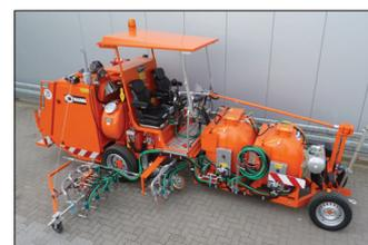
**H33** en Cairo/Égypte avec système du réservoir sous pression pour peinture à froid, 1 x 460 l et 2 x 220 l réservoir sous pression, marqueur aéroportuaire 90 cm avec chacun 4 pistolets de peinture et billes de verre ainsi que chacun 2 pistolets de peinture et billes de verre pour des taxiways
