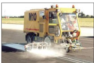
**H35** en Dublin/Irlande avec des pompes pour peinture à froid de 1-comp. ainsi que système du réservoir sous pression pour peinture à froid, marqueur aéroportuaire 90 cm avec 4 pistolets de peinture ainsi que 1 pistolet de peinture pour des taxiways, 1 x 320 l et 1 x 225 l réservoirs sous pression
