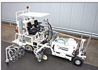
H18 para Royal Air Force/UK con sistema de pinturas en frío de 1-componente Airless (dos bombas) con marcador aeroportuario de 90 cm y 4 pistolas de pintura y esferas así como 3 pistolas de pintura y esferas para aplicar taxiways (negro/ amarillo/negro), 2 x 225 l depósito presurizado
