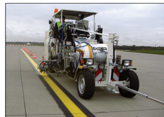
H33 en Hamburgo / Alemania con sistema de pinturas en frío de 1-componente Airless con 5 bombas Airless, 1 x 460 l y 2 x 220 l así como 2 x 110 l depósitos presurizados ...
