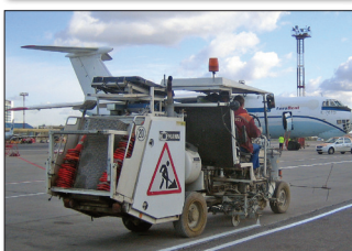
H26 en San Petersburgo/Rusia equipada para pinturas en frío de 1-componente así como sistema Airless 98:2 para plásticas en frío pulverizables de 2-componentes, depósito presurizado de 460 l, para el uso con una pistola de pintura o bien una pistola de 2-componentes para taxiways
