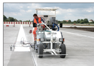
H26 en el terreno de la compañía Airbus, Hamburgo / Alemania equipada con sistema de pinturas en frío de 1-componente Airless así como pinturas plásticas en frío pulverizables de 2-componentes Airless M98:2, 460 l depósito presurizado así como marcador aeroportuario de 90 cm y 3 pistolas de pintura
