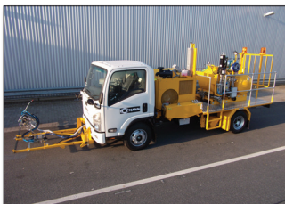
H36-800P en Hong Kong/China para pinturas en frío de 1-componente Airless con marcador aeroportuario de 90 cm y 4 pistolas de pintura y esferas, 1 x 385 l y 2 x 220 l (dividido) depósitos presurizados
