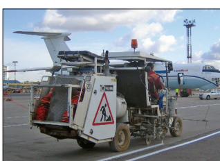
H26 v Petrohradu / Rusko, stroj pro značení 1K barvami za studena a 2K stříkanými plasty za studena v poměru mísení 98:2 systémem Airless, tlakový zásobník o objemu 460 l, značkovací jednotka s jednou barvou pistolí nebo 2K stříkácí pistolí pro značení pruhu pro „taxi“
