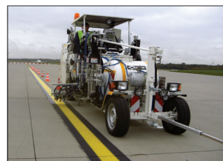
H36-800P Hongkong/Čína, stroj pro značení 1K barvami za studena systémem Airless, značkovací jednotka pro značení šířky čáry 90 cm se 4 barvovými a 4 perlovými pistolemi, tlakový zásobník o objemu 1x385 l nebo rozdělený na 2x220 l
