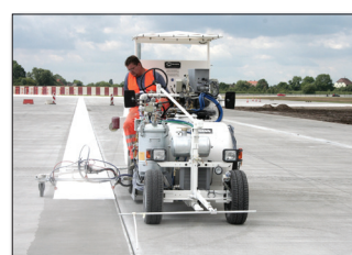
H26 v Petrohradu / Rusko, stroj pro značení 1K barvami za studena a 2K stříkanými plasty za studena v poměru mísení 98:2 systémem Airless, tlakový zásobník o objemu 460 l, značkovací jednotka s jednou barvou pistolí nebo 2K stříkácí pistolí pro značení pruhu pro „taxi“
