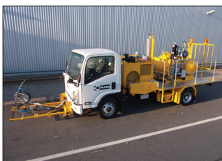
H36-800P Hongkong/Čína, stroj pro značení 1K barvami za studena systémem Airless, značkovací jednotka pro značení šířky čáry 90 cm se 4 barvovými a 4 perlovými pistolemi, tlakový zásobník o objemu 1x385 l nebo rozdělený na 2x220 l
