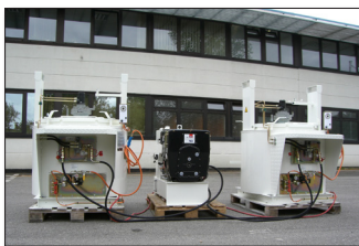
③ D350 Dva kotle D350 s plynovým hořákem, 10 kW generátor
