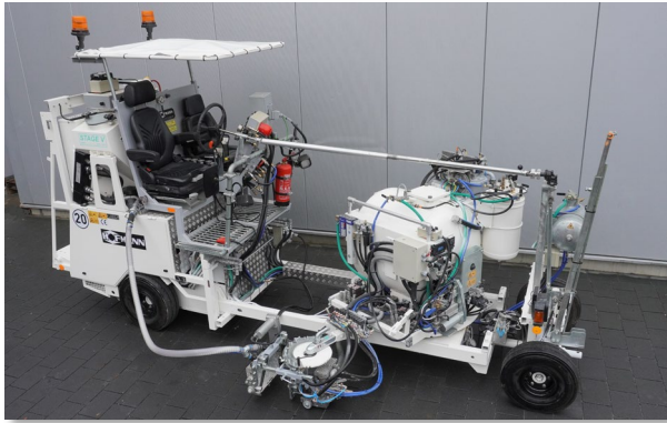
Положение экструдера при нанесении разметки: экструдер на стороне, около бака для материала
