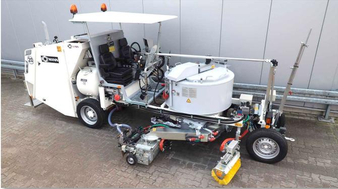
Положение при разметке: Поворотный экструдер сбоку около бака
