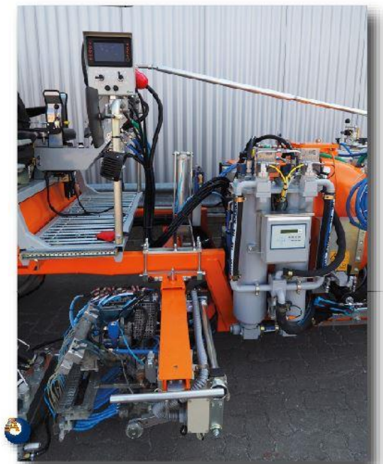
Bomba de fuelle para componente de base de 98% y bomba de engranajes para endurecedor de 2%, para pinturas plásticas en frío 2c con MALCON4E
