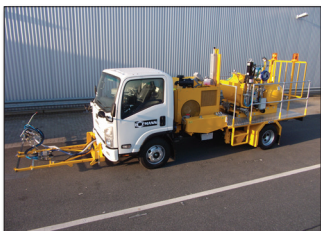
H36-800P in Hongkong/China mit 1K-Kaltfarben Airless System für den Einsatz mit 90 cm Breitstrichmarkeur mit 4 Farbpistolen und Perlpietolen, 1 x 385 ltr und 2 x 220 ltr (geteilt) Druckbehälter
