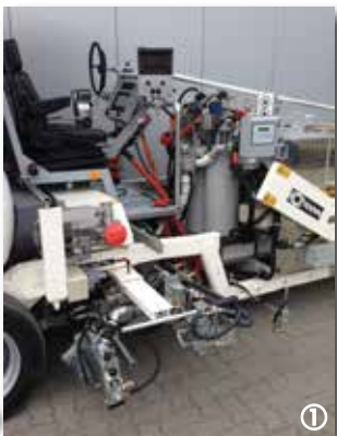
Способ дозирования: сильфонный насос для распыляемых термопластиков с MALCON4E
