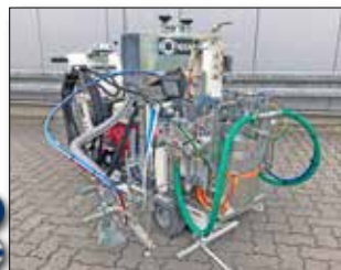
H9-1 Airless 2c M98:2 équipée pour procédé Airless (procédé haute pression), peinture à froid 1 composant ainsi que pour l'enduits à froid 2c pulvérisés, proportions de mélange 98:2
