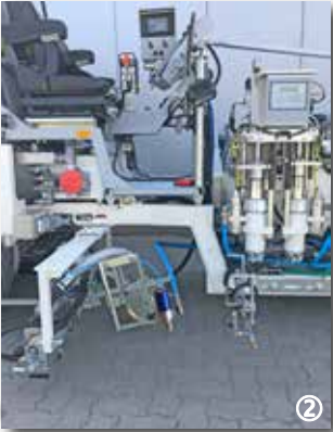
Dosierverfahren: Plungerpumpe für Kaltfarben Airless (Hochdruckverfahren) oder Airspray (Niederdruckverfahren) mit MALCON4E
