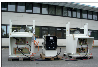
③ D350 Zwei D350 mit Propangasbrenner, 10 kW-Hydraulikaggregat
